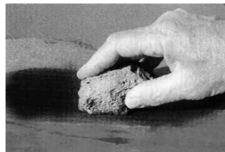
Schleifen von Mahagoniholz mit Formbimsstein und Leinölfirnis.
