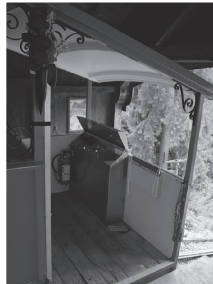
Links der Führerstand der Reichenbachfallbahn, rechts jener der Giessbachbahn, beide nach der Erneuerung der Wagensteuerung.
