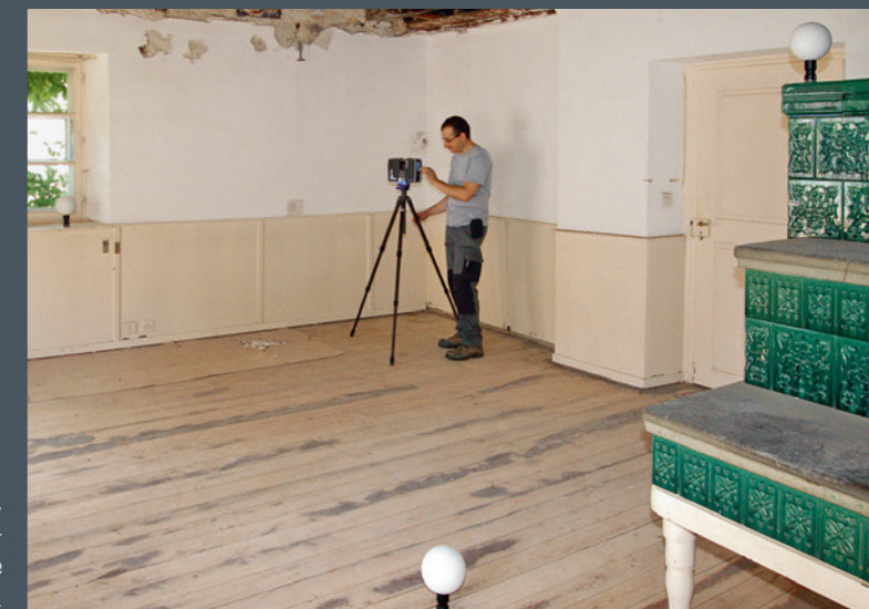
Ein 3D-Laserscanner ist in der Lage, zentimetergenaue und in die Landeskoordinaten eingepasste dreidimensionale «Farbfotos» seiner Umgebung zu schiessen.
