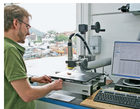
Der Scherbendrucker beschriftet Fundobjekte und erstellt automatisch bei jedem Vorgang einen passenden Datensatz in der archäologischen Datenbank (Computer rechts).
