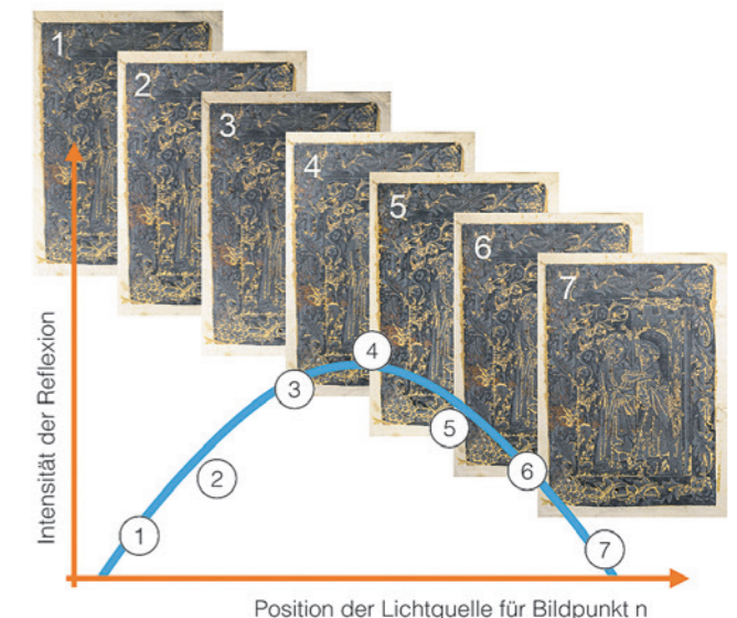
Abb. 4 Die Abbildung zeigt sieben exemplarische Fotografien. Jedes dieser Bilder wurde aus einer anderen Richtung beleuchtet. Nach der Aufnahme wird die Helligkeit der deckungsgleichen Bildpunkte ermittelt, die als Datensatz zur weiteren Analyse verwendet werden. In einem zweiten Schritt wird eine mathematische Funktion so gewählt, dass die mittlere Abweichung der Messpunkte zum parabelförmigen, blau eingezeichneten Verlauf der mathematischen Funktion minimal ist.
