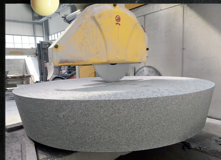
Lavorazione con una fresa a controllo numerico di una fontana circolare presso le cave di Cresciano, 2018: Fontana per il comune di Oberägeri, scultore Karl Imfeld.
