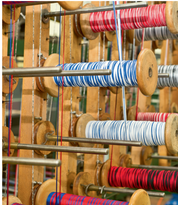
▶ Spulen mit bunten Kettfäden versorgen einen rund 140-jährigen Webstuhl aus der früheren Heimindustrie mit Garn.
