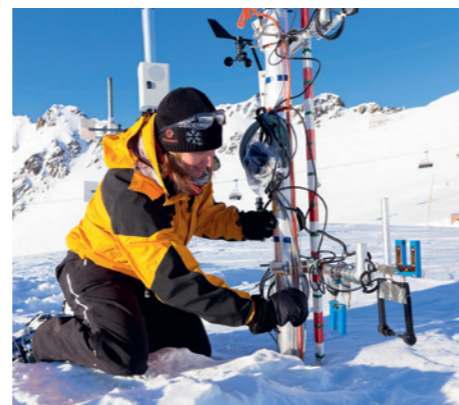
Abb. 3: Jeden Tag seit 84 Jahren führt das SLF auf dem Weissfluhjoch, Davos, Schneemessungen durch. Hier die moderne Messung einer Schneeverfrachtung.
