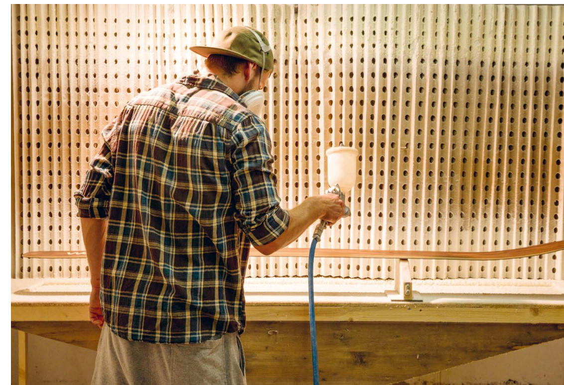
Application de la couche de finition au pistolet. © Paul Rogivue
