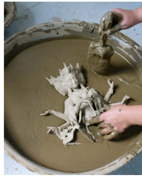
Abb. 8: Viele bei uns verloren gegangene Arbeitstechniken können in der Dritten Welt beobachtet werden, wo die Kunsthandwerker/-innen noch alle Feinissen und Tricks beherrschen. Hier ein Beispiel aus Patan (Nepal) mit der Herstellung der Gussformen über den Bienenwachsmodellen für Buddha-Statuen: links die inneren Schichten aus feinem geschlammtem Lehm, rechts die äussere Umhüllung mit Lehm und Reishäcksel.
