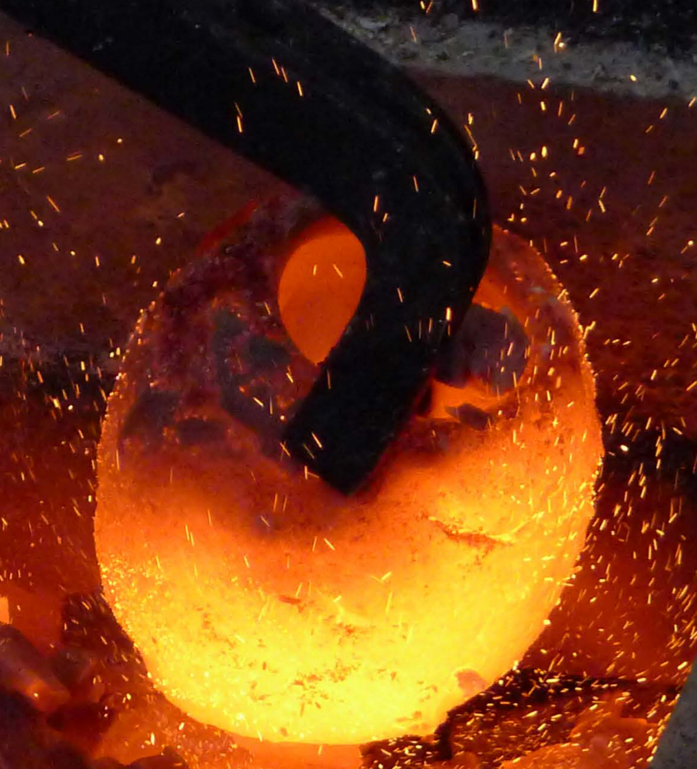
Abb. 1: Rekonstruierte «römische» Schmelztiegel auf dem Prüfstand und im archäologischen Experiment erprobt. Oben rechts: hergestellt mit lokalem Tiegelton aus Augst-Zelglihof (linke Hälfte rein, rechte mit grobem Quarzsand gemagert = Massnahme für bessere Hitzebeständigkeit). Oben links: importiert mit hellem «Hupperton» von Châtelat im Berner Jura. Links gross: Schmelzversuch im Holzkohleofen.
