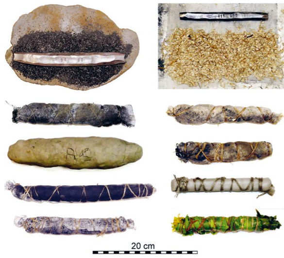
Abb. 6: «Einpacken» von Weicheisen-Barren zur «Aufkohlung» in einer Ummantelung mit kohlenstoffreicher Holzkohle (links oben) und anderen organischen Materialien (unten). Als Abdichtung dient eine Lehmumhüllung des Ganzen (Mitte links), die sorgfältig getrocknet werden muss, ohne Risse zu bekommen.
