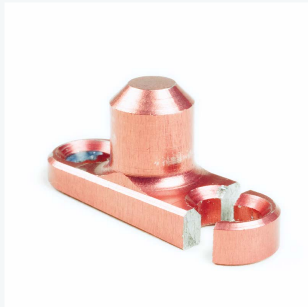
2: Verriegelungszapfen Dynafit DNA Skitourenschuh; Daniel Schuster. Damit der Skischuh bei der Abfahrt die Kraft vom Fahrer auf den Ski wieder übertragen kann, musste der gebrochene Verriegelungszapfen ersetzt werden. Der neue Zapfen ist aus Aluminium gefräst.
