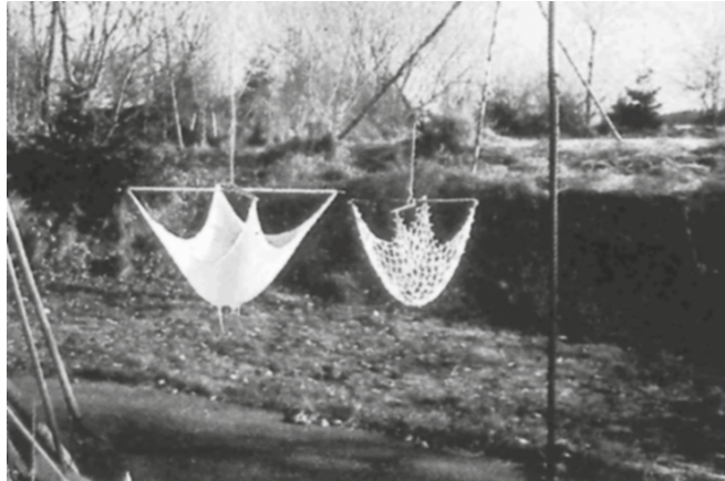
Beim Experimentieren mit hängenden Tüchern und Netzen ermittelte Heinz Isler die günstigste Schalenform.
